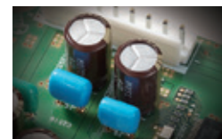
Stromversorgungsschaltung mit schwach verstärkendem Folienelektrolytkondensator, Aluminiumfolienkondensator, hochkapazitivem Kondensator
