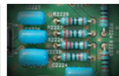
Strom-Spannungs-Konversion, Analogausgang, nichtmagnetischer Kohleschichtwiderstand
