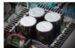
Stromversorgungsschaltung mit schwach verstärkendem Folienelektrolytkondensator, Aluminiumfolienkondensator, hochkapazitivem Kondensator
