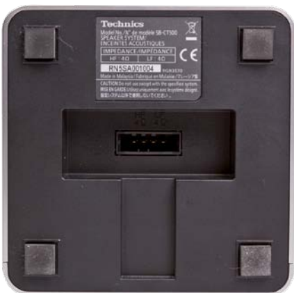
Unterseite der Lautsprecher: Durch das Fehlen einer Aussparung für das Kabel stehen die Boxen leicht nach vorne geneigt
